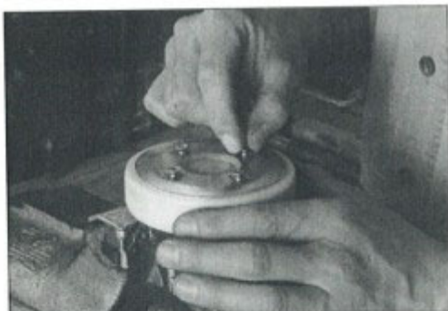
Bilde 46: Bytt hjulbelegg, sett i skruene og...
