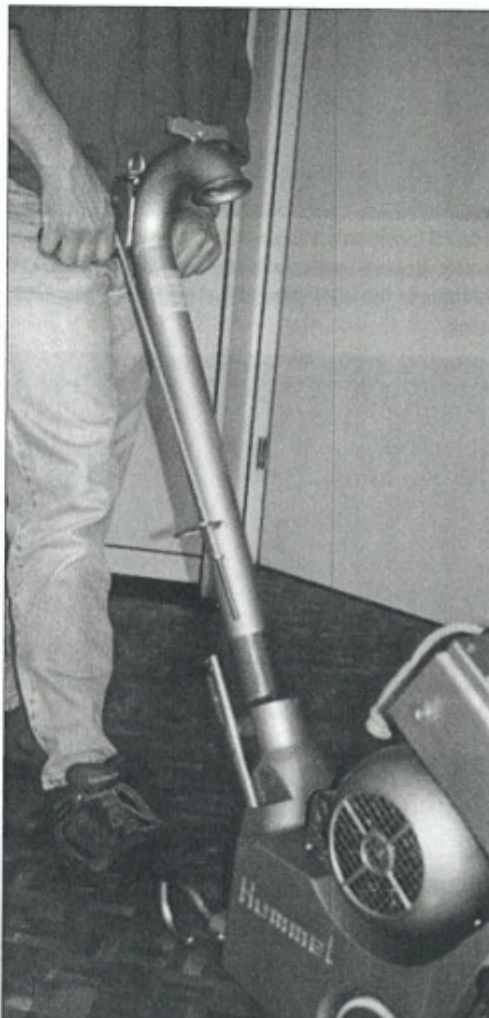
Bilde 15: Etter at vingeskruen og vingemutteren på staget er løsnet kan føringsrøret dras ut av maskinen.
