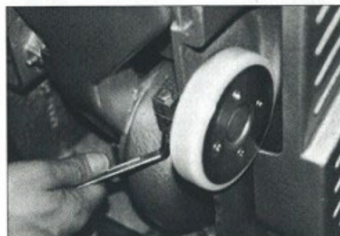
Bilde 31: ...løsne skruen ved høyre hjulfeste og...
