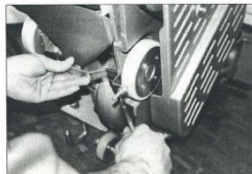
Bilde 32: ..still inn den høyre kanten etter malen.
