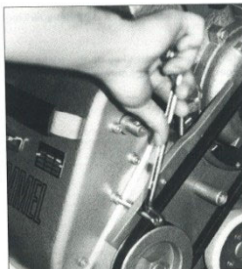
Bilde 25: ...ta forsiktig ut slipevalsen med 6kantnøkkelen.
