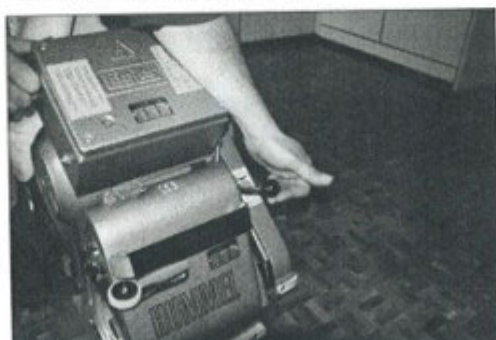
Bilde 23: ...slipevalsen slippes ned, og slipebåndet tas ut.
