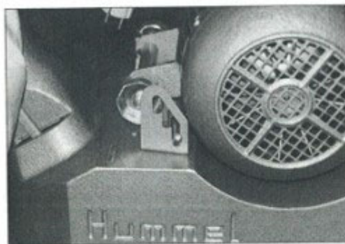
Bilde 14: Med innstillingsspaken kan ulike slipevalstrykk stilles inn.
