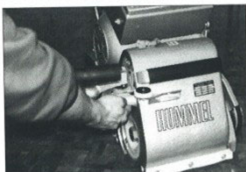
Bilde 26: Løsne de tre inner6kantskruene, om nødvendig bruk stjernefastnøkkelen som ekstra kraftarm.
