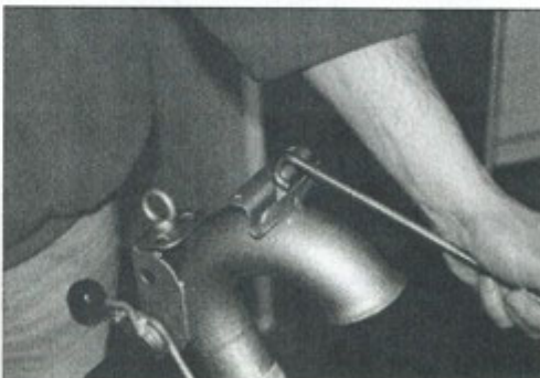
Bilde 5: Monter kabelstangen i brakettens senterhull.
