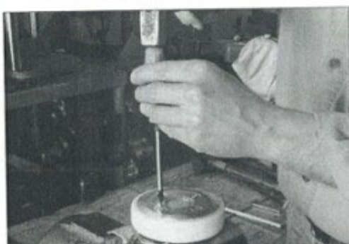
Bilde 45: Fastsittende skruer kan løsnes med hjelp av lette hammerslag PS: skrutrekkeren må være tilpasset skruen.
