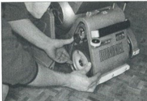
Bilde 8: ...skyv inn et slipebånd så langt over slipe- og spennvalse at slipevalse dekkes fullstendig av båndet.
