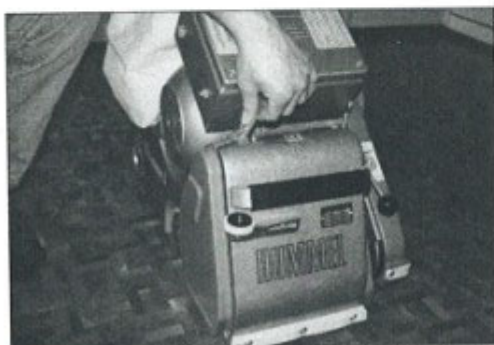
Bilde 13: Etter utført bytte av slipebåndet skal dekselet igjen settes på plass.
