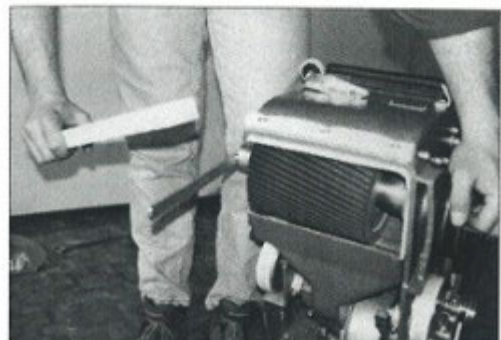
Bilde 34: Løsne valsemutteren (venstregjenget) ved behov med lette slag, aldri med hammer!
