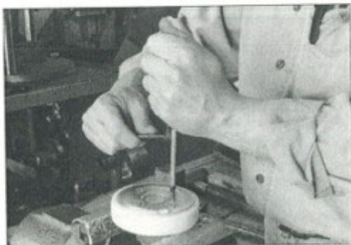
Bilde 47: ...Dra deretter ordentlig til uten å skade gjengene.
