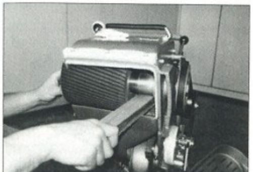
Bilde 36: Dersom valsen sitter fast kan man bende forsiktig med en trestokk, bruk ikke makt!
