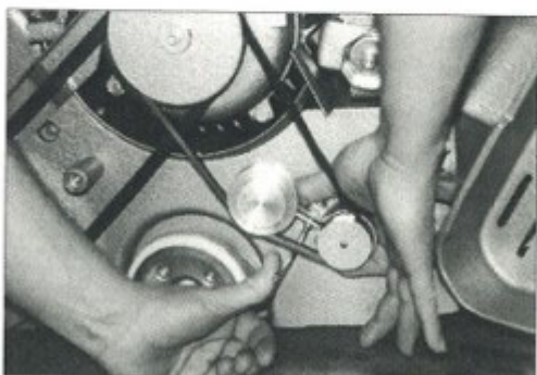
Bilde 51: Stram støvsugerdrivreimen med strammeklemmen, og dra til klemskruen.
