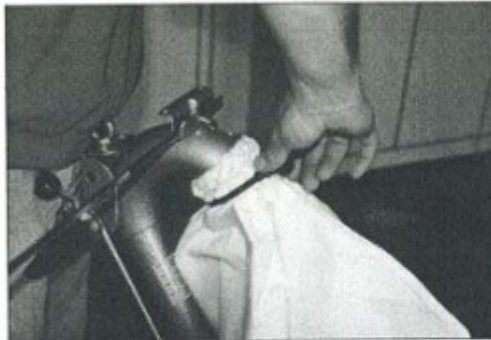
Bilde 6: Monter støvposen og fest den ordentlig. Bruk Multit Clip hurtigstrammeren.
