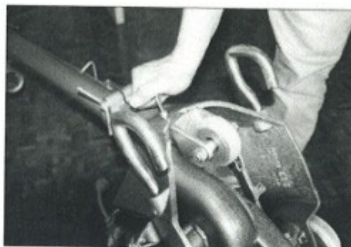
Bilde 41: Tipp maskinen forover over bærehåndtaket, og løsne festeskruen.
