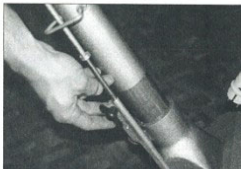
Bilde 2: Når føringsrøret settes i må nedsenkningshåndtaket tres ordentlig i.
