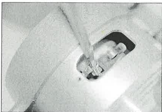
Bilde 30: ...løsne klemmeskruene, uten at deler faller ned i motoren, før...
