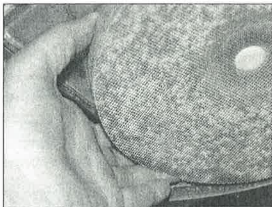
Bilde 8: Grip bak slipeskiven med fingertuppene og trekk den ut framover.
