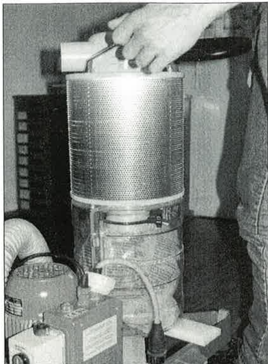
Bilde 23: ...løsne så alle fire hettekruser på lokket til støvfilteret.
