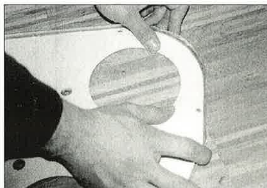
Bilde 39: Trykk tettingen jevnt på, spesielt i området rundt slipetallerkenholderne.
