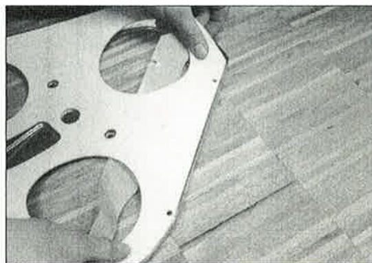
Bilde 38: Fest først den nye tettingen på en side, før du legger på hele.
