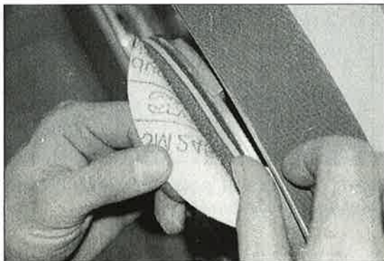
Bilde 13: Gripi utsparingen for å trekke av brukte slipeskiver.
