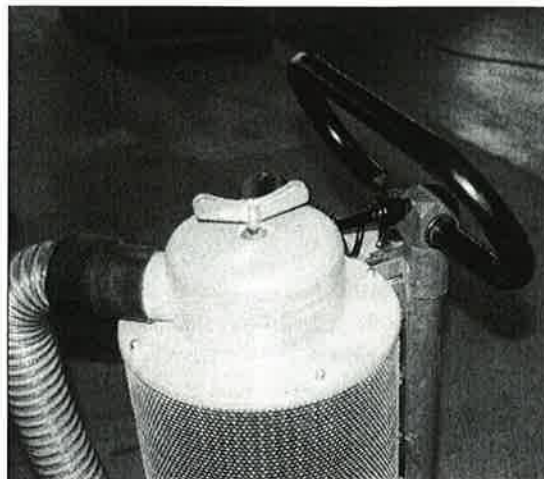
Bilde 2: For å vippe maskinen, løsne klemmespaken, og dreie håndtaket framover.
