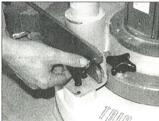
Bilde 20: Etter løsningen av krysshåndtakene, kan kjørestativet kjøres bakover.
