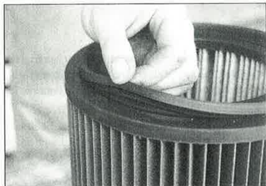
Bilde 24: Sjekk at tetningen er ren og riktig montert på filteret, før du setter inn filteret.
