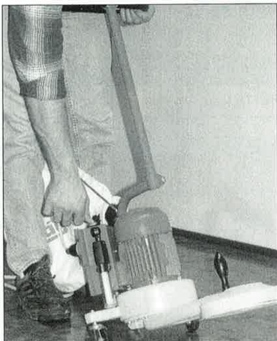
Bilde 16: Vipp UNICO bakover, hold fast med den ene hånden og skru på med den andre.
