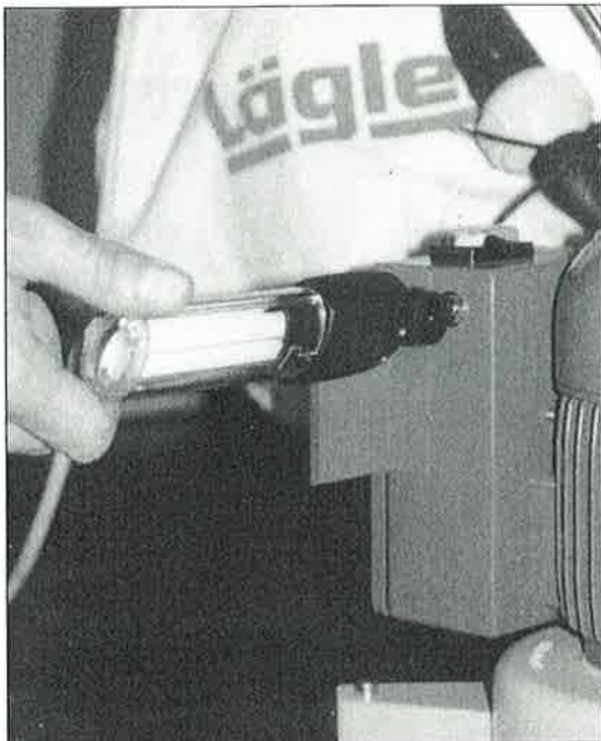
Bilde 15: Arbeidslampen kan vippes til side og dreies nedover.
