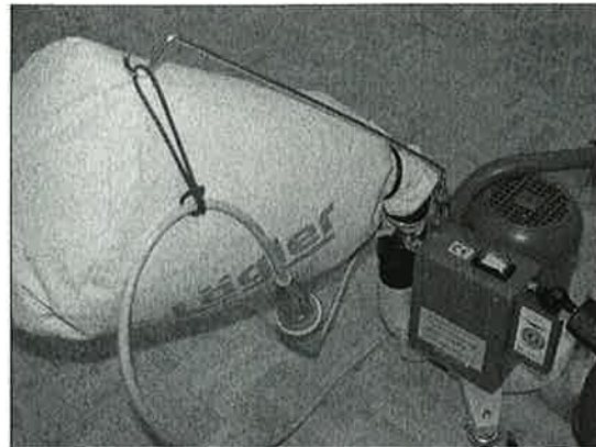
Bilde 12: Før skjøtekabelen fra venstre mellom kabelholderen og støvposen
