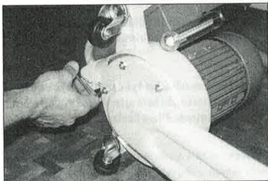
Bilde 30: ...remspenneskruen skrues til med 3-4 omdreininger, og forsatsen festes.
