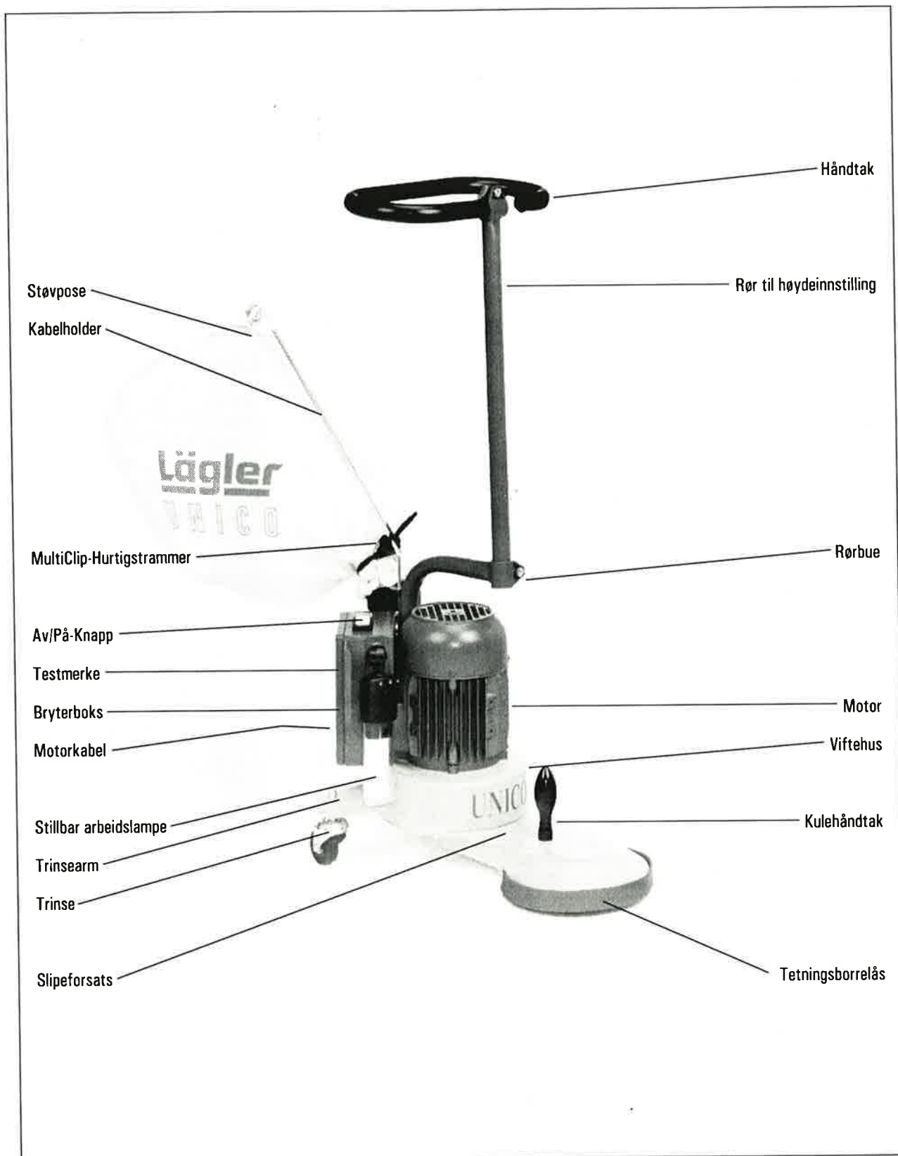
Bilde 1: Byggedeler til kantslipemaskinen UNICO
