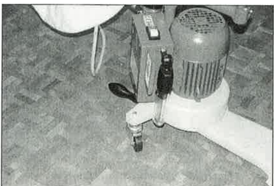
Bilde 11: Kulehåndtaket kan også monteres på trinsehjularmene.
