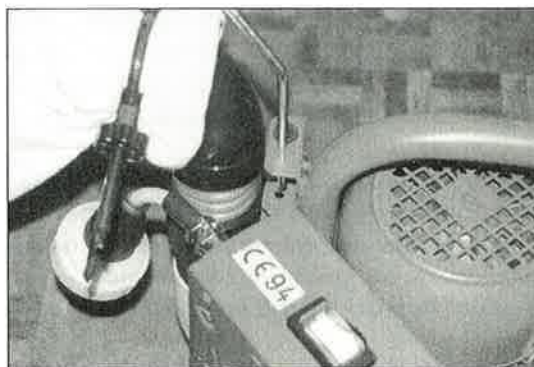
Bilde 5: Stikk kabelholderen i festet på maskinen
