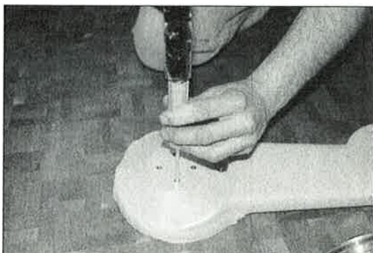
Bilde 35: ...skruene til slipetallerkenfestet løsnes med lette hammerslag, for...
