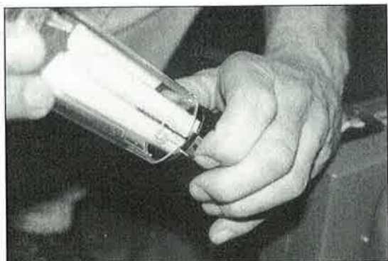
Bilde 31: Trykk sammen de to laskene på dekslet, og ta av glassrøret,...
